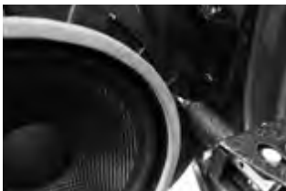
Rivetage du haut-parleur IS 690TOY ou IC 690TOY (avec les rivets fournis)
