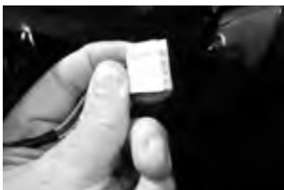
TOYOTA® factory tweeter connector
