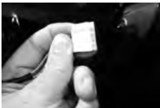
Connecteur du tweeter d'origine TOYOTA®
