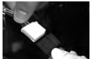
Connecteur du tweeter d'origine TOYOTA® branché sur le connecteur du kit IS 165TOY
