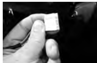
Connecteur du tweeter d'origine TOYOTA® (IS 690TOY)
