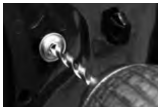
Dérivage du haut-parleur d'origine (x3 rivets/HP)
