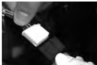
Connecteur du tweeter d'origine TOYOTA® branché sur le connecteur du kit IS 690TOY
